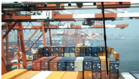
Fig. 1: 海上コンテナによる輸送の例(上: Roll-on roll-off 型コンテナ船のトレーラーヘッドによる荷役, 下: Lift-on lift-off 型コンテナ船の前部デッキ)
