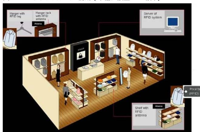
図10 RFID タグシステムの構成(アパレル店舗に設置した場合)
